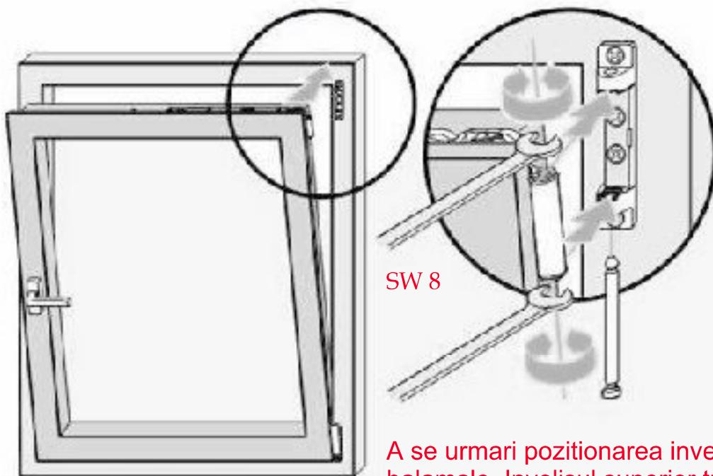
A se urmari pozitionarea invelisurilor pe balamale. Invelisul superior trebuie sa fie parallel cu cel de pe balamaua de jos.
